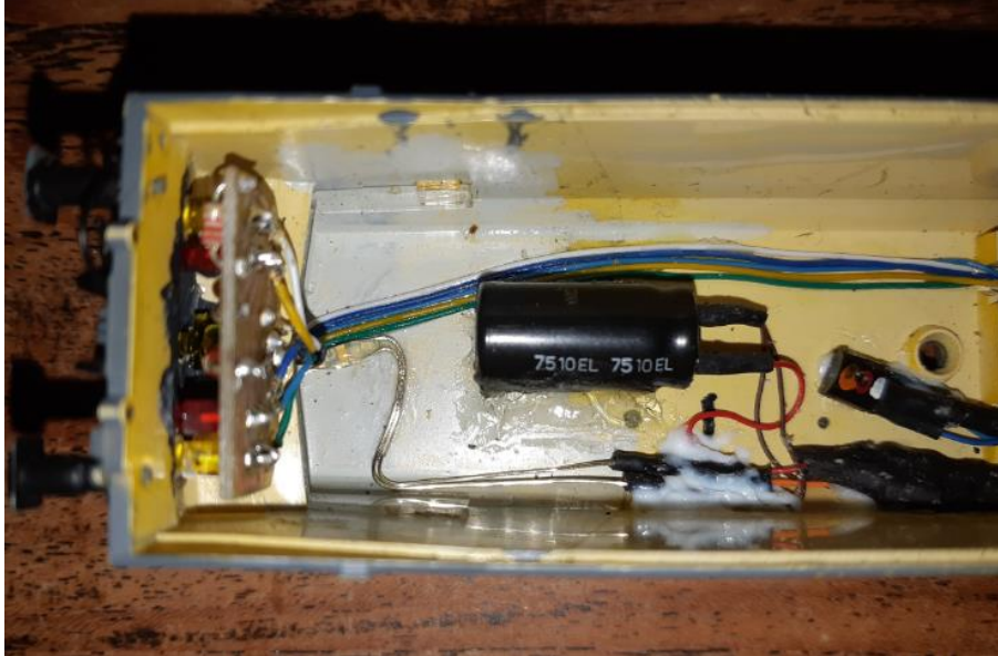
Cab. 2: LED print, cabine licht, stroombuffer, PNP transistor voor de sluitverlichting...
